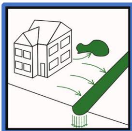
Wenn die natürlichen Gelände- und Bodenverhältnisse es zulassen, kann unbelastetes Niederschlagswasser durch Versickerung dem Grundwasser zugeführt werden. Die Versickerung kann breitflächig über Mulden, linienförmig über Rigolen oder punktförmig über Sickerschächte erfolgen. Der Boden muss für die Versickerung ausreichend durchlässig sein. Eine tiefe Durchwurzelung des Bodens steigert die Versickerungsleistung.
