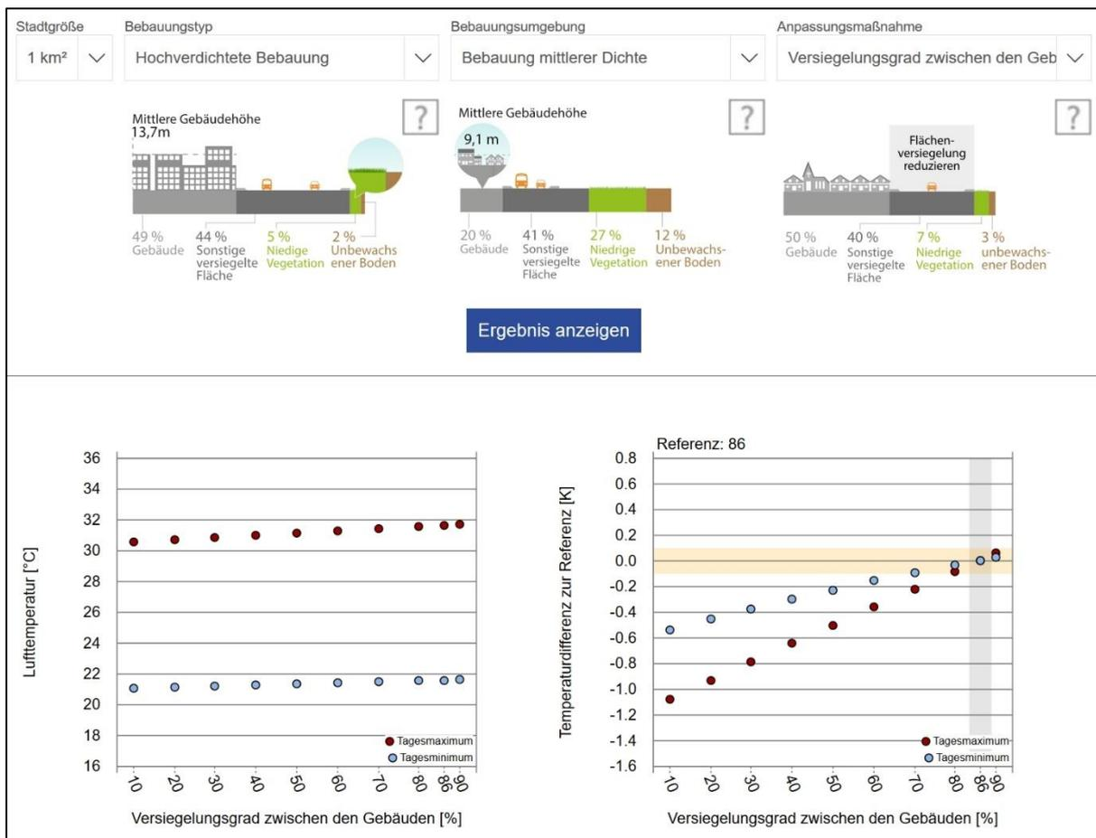
Abbildung 5-19 Beispielhafte Wirkungsanalyse für Grünquotienten in hoch verdichteter Bebauung ([www.dwd.de/DE/leistungen/inkas/inkas\\_nrw\\_wirkungsanalyse](http://www.dwd.de/DE/leistungen/inkas/inkas_nrw_wirkungsanalyse))
