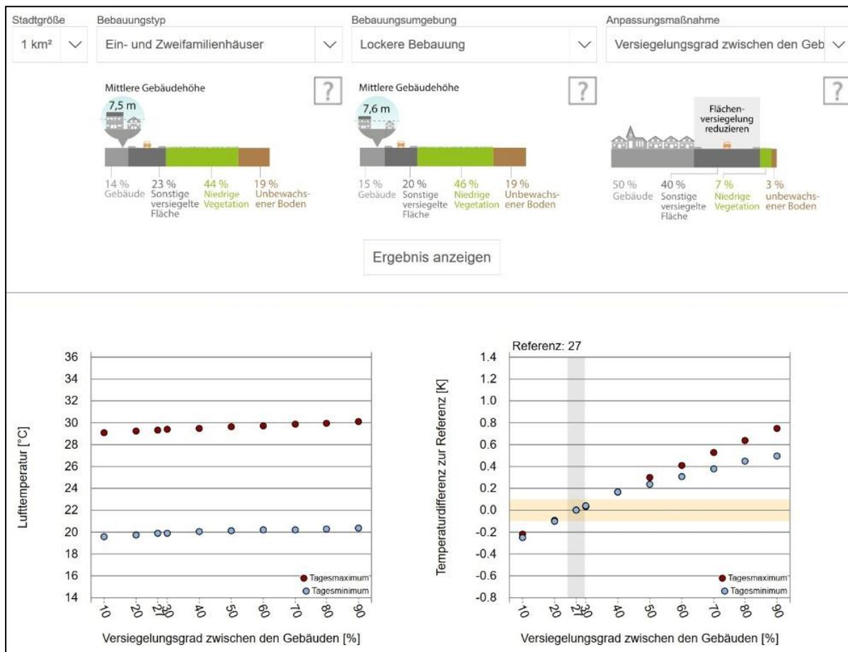
Abbildung 5-17 Beispielhafte Wirkungsanalyse für Grünquotienten im Bebauungstyp „Ein- und Zweifamilienhäuser“ ([www.dwd.de/DE/leistungen/inkas/inkas\\_nrw\\_wirkungsanalyse](http://www.dwd.de/DE/leistungen/inkas/inkas_nrw_wirkungsanalyse))
