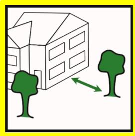
Empfindliche Nutzungen können durch bauliche Ausrichtungen und das Einhalten von Abstandsflächen vor Beschädigungen geschützt werden. Durch eine Ausrichtung der Gebäude längs zur Hauptwindrichtung, die durch die Leitwirkung des Rheintals zwischen Winden aus westlichen bis südlichen Richtungen schwankt, kann die Windlast reduziert werden. Die Längsausrichtung fördert zudem die Belüftung und reduziert damit die Hitzebelastung im Gewerbegebiet.
