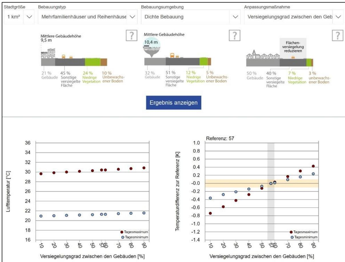
Abbildung 5-18 Beispielhafte Wirkungsanalyse für Grünquotienten im Bebauungstyp „Mehrfamilienhäuser“ ([www.dwd.de/DE/leistungen/inkas/inkas\\_nrw\\_wirkungsanalyse](http://www.dwd.de/DE/leistungen/inkas/inkas_nrw_wirkungsanalyse))
