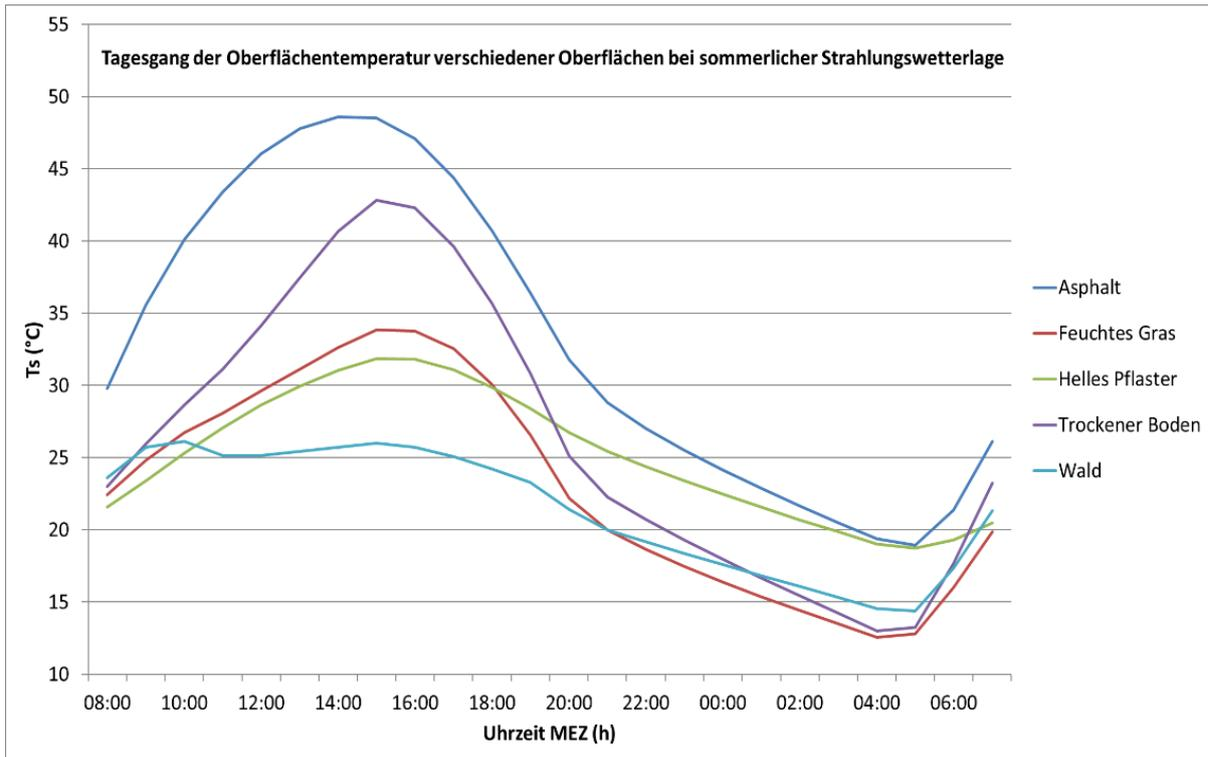
Abbildung 5-1 Tagesgang der Oberflächentemperaturen verschiedener Oberflächen
